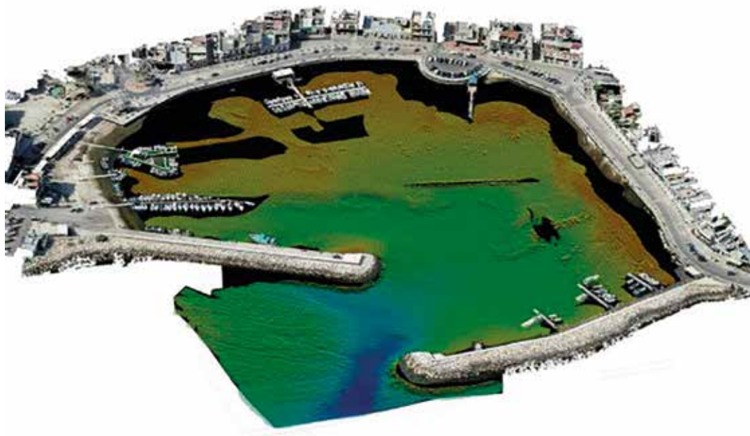
Vista Nord tridimensionale dell'area rilevata attraverso rilievo laser scanner nell'anno 2021 (fonte: elaborati di gara redatti da PRISMA S.R.L., Aggiudicatario dell'appalto indetto ai fini del progetto APPECCA).
