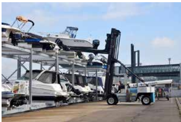
Esempio porto a secco - mezzi per la movimentazione (fonte: sito web Magellanoblog)
